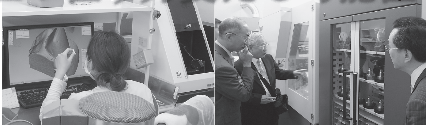
上：小型の切削加工機で技工物を削り出す様子。左下：スキャナーで読み取った模型を基にパソコンで設計する。右下：大型の切削加工機の前で質問する伊津進弘理事・相談役(中央)、説明する樋口鎮央氏(右)
