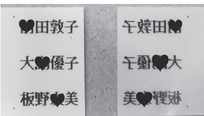
図1 左は白テープに正印字、右は透明テープに鏡像印字
